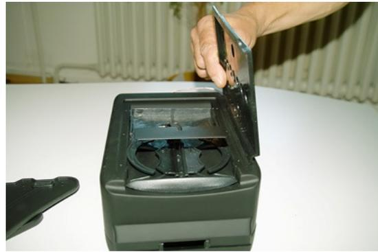
2. Befestigen Sie die beiden Konsolenhalter an dem Unterteil
